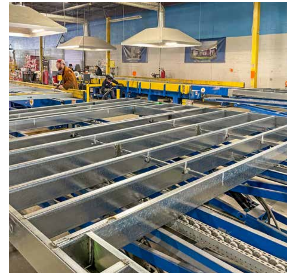
Een stalen frame is lichter dan een basis van beton of hout.
